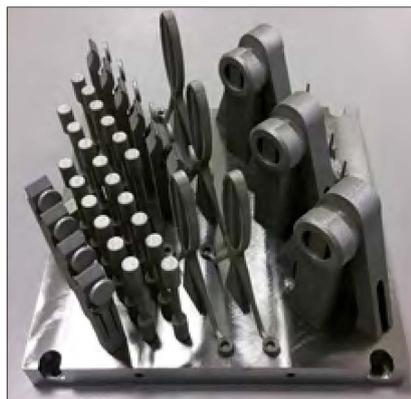
Musterbauteile mit Stützstrukturen werden vollautomatisch bearbeitet.
